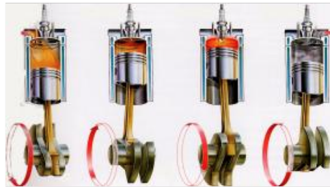
So arbeitet ein Viertaktmotor: ansaugen - verdichten - zünden - arbeiten.
