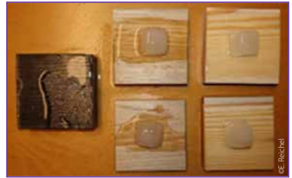
Abb. 2: Experiment Schmelzen von Eis auf unterschiedlichen Stoffen – von links nach rechts: Eisen, Hartholz, Weichholz (30 Minuten nach dem Start)
