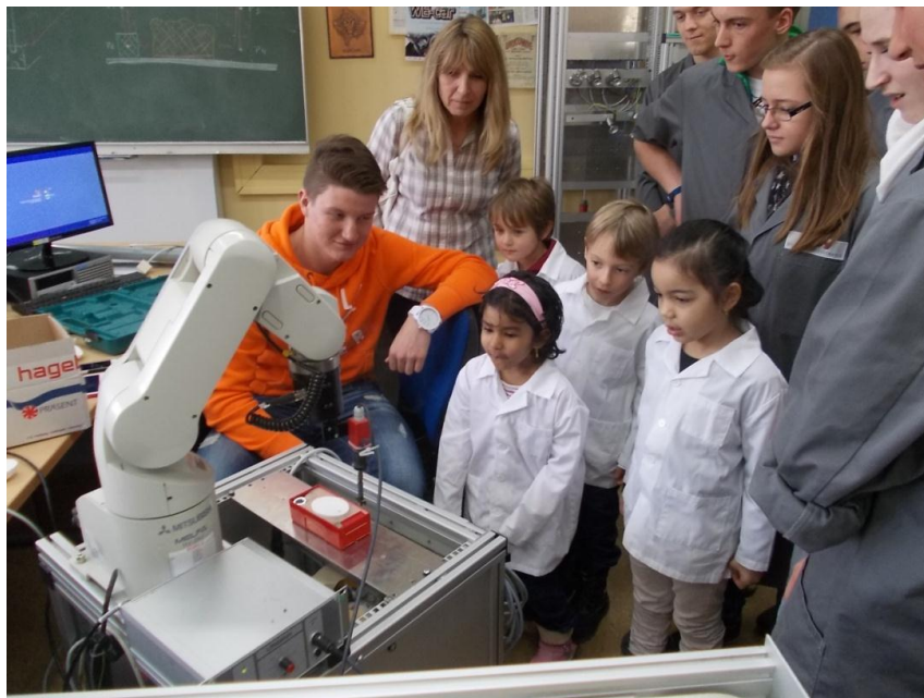
Der Roboter fräst das Styropor-Ei für den Elektromotor aus.
