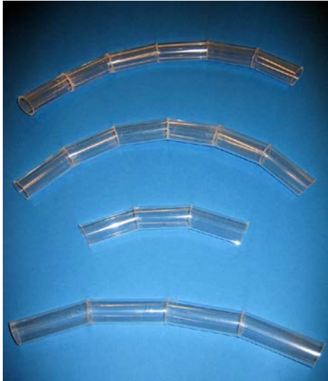
Abb10: Kurvenelemente aus zusammengesetzten Einzelkomponenten für die nächste 360°-Kurve am 2ten Stützweiler.
