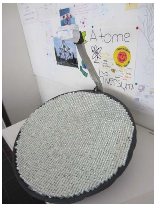
Abb. 10 Ein beeindruckender Solarkocher, der von einer Schülergruppe gebaut wurde.
