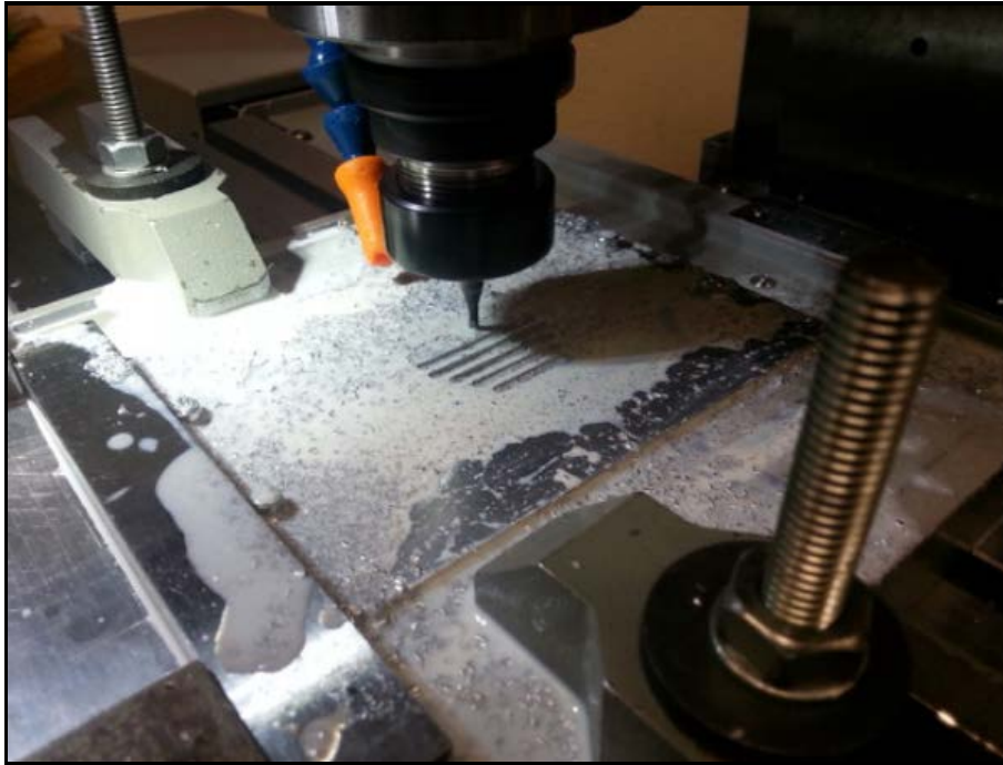
Abbildung 14: Aluminiumzerspanung, (Eigene Darstellung)
