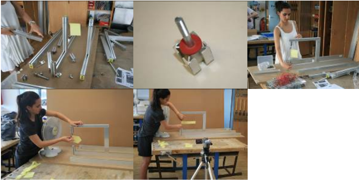
Entwicklung der Testkonstruktion und –montage mit Kamerastandort
