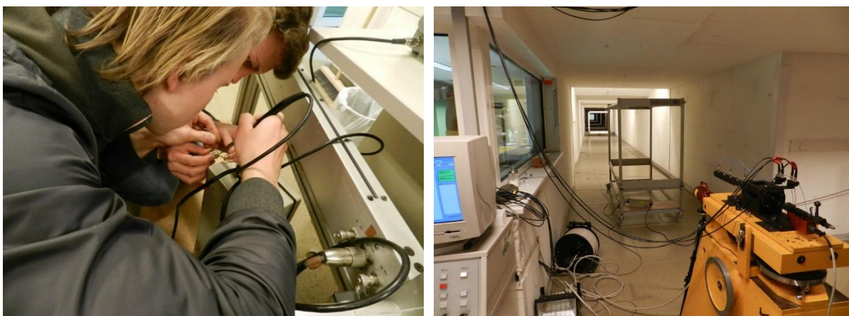
Schüler bei der Erfassung der Messdaten im Schusskanal, rechts: Messaufbau: im Vordergrund der Abschussbock mit dem Gasdruckmessaufbau, davor in 2m Entfernung der ersten Lichtschranke zur Geschwindigkeitsmessung, im Hintergrund in 20m Entfernung das Target zur Erfassung der Treffpunktlage.
