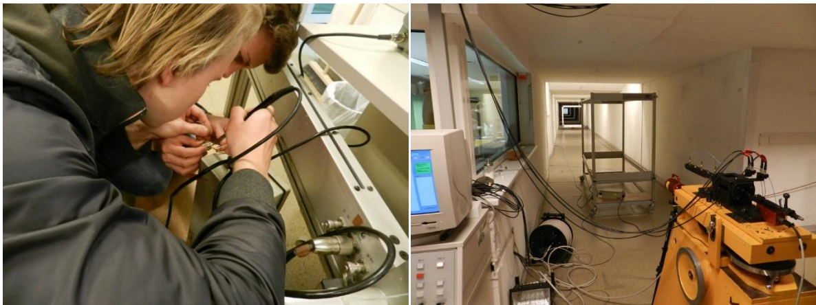
Abbildung 3: links: Schüler bei der Erfassung der Messdaten im Schusskanal, rechts: Messaufbau: im Vordergrund der Abschussbock mit dem Gasdruckmessaufbau, davor in 2m Entfernung der ersten Lichtschranke zur Geschwindigkeitsmessung, im Hintergrund in 20m Entfernung das Target zur Erfassung der Treffpunktlage.
