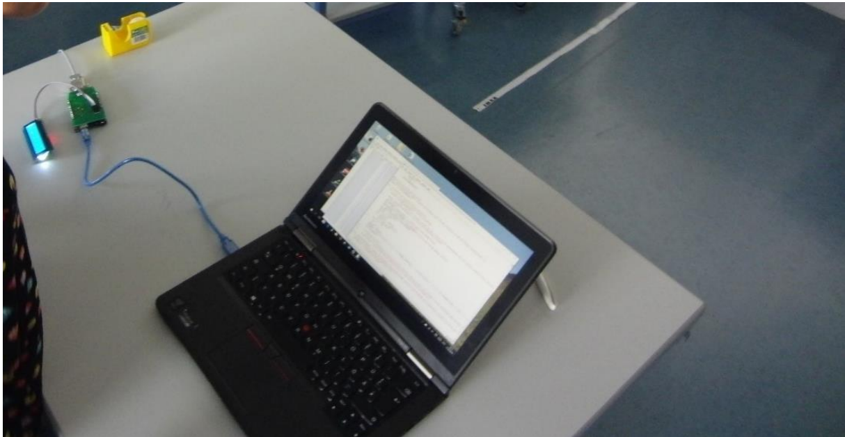
Abbildung: Berechnung der Wegstrecke aus Beschleunigungswerten (Sensor ist auf den Vorbereitungstisch angeklebt – die Beschleunigungswerte werden über USB-Schnittstelle eingelesen und mit Hilfe eines Python-Programms ausgewertet.)
