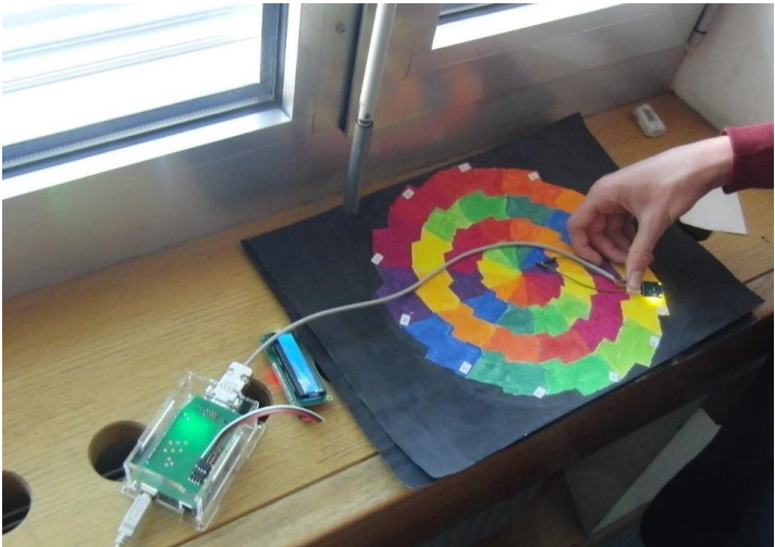
Abbildung: Messung eines selbstgemalten Farbkreises mit einem Farbsensor
