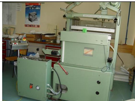
**Abbildung 13: Vakuumformmaschine mit neuem Schalterpult**
