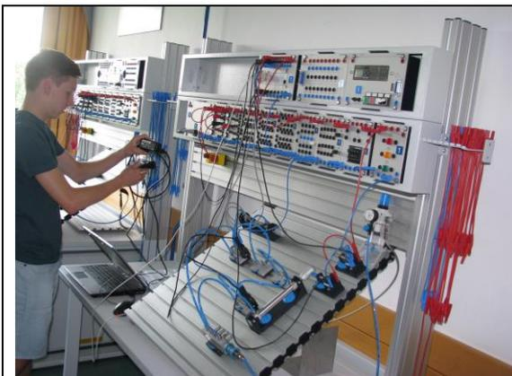
**Abbildung 5: Schüler programmieren und probieren die Steuerung für den Scherenhubtisch**
