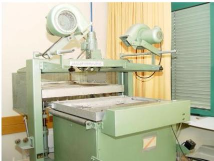
Abbildung 1: Vakuumtiefziehanlage
