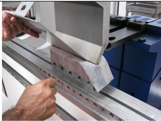
**Abbildung 7: Teile werden an der Biegemaschine in Form gebracht**
