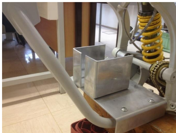
Abbildung 7: Anpassung der Motorhalterung
