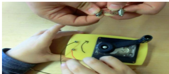
Abb. 10 Stromkreis mit Dynamo
