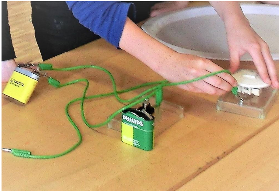
Abb. 9 Stromkreis mit Schalter
