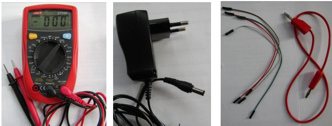
Bild 3.3 a. Digitalmultimeter b. Steckernetzgerät c. female-Jumper und Messleitung
