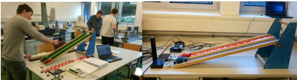
Abbildung 2: Erarbeitung der Versuchsumsetzung im Labor mit den SchülerInnen der EUREGIO HTBLVA Ferlach. Einsatz der Kraftmessdose zur Darstellung von Kräften.
