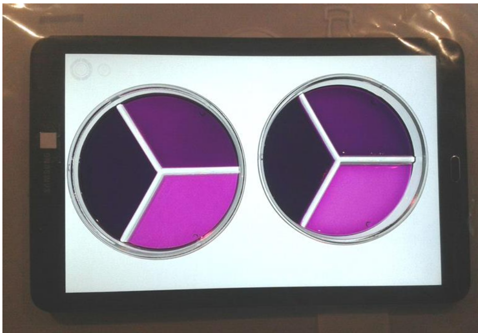
Abbildung: dreigeteilte Petrischalen: linke Seite: unterschiedliche Konzentration mit voller Schichthöhe rechte Seite: unterschiedliche Schichtdicke mit gleicher Konzentration.
