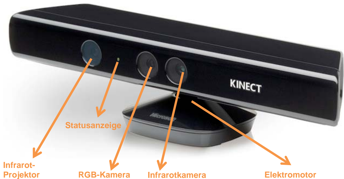
Abbildung 1: Beschreibung des Kinectsensors (vgl. Borenstein 2012, p. 10)
