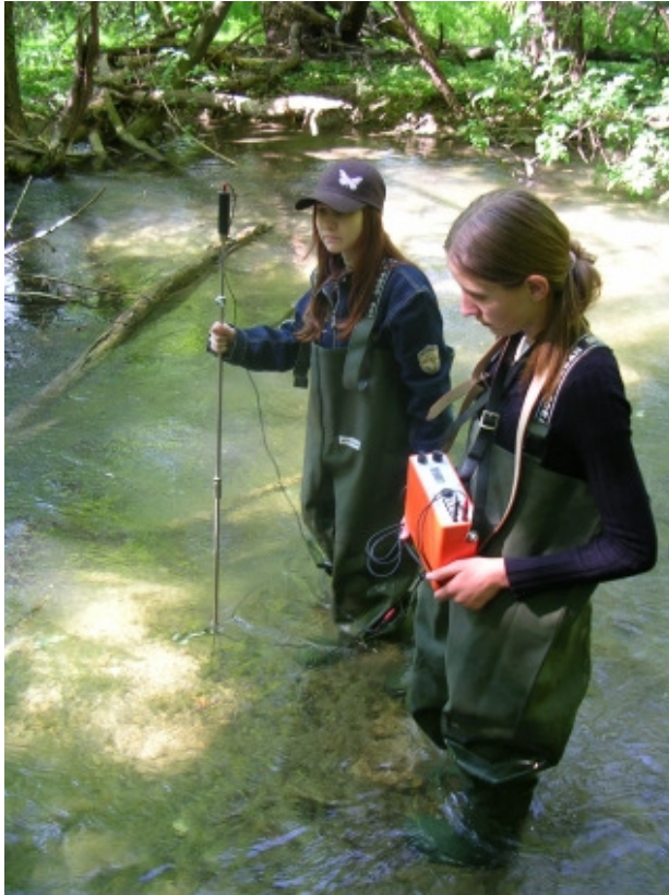
Abbildung 10: Fließgeschwindigkeitsmessung mit Ott Z 2
