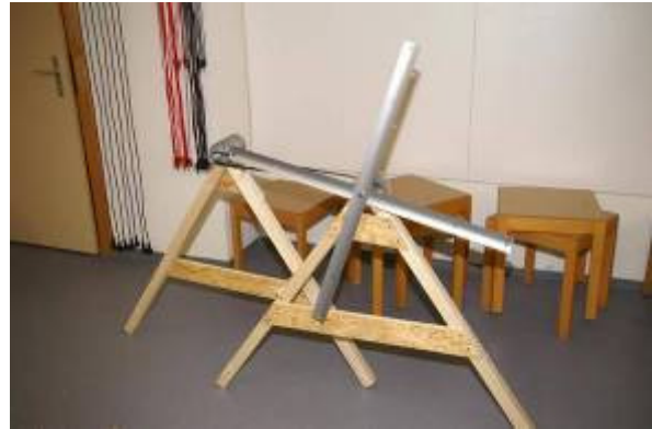
Windrad-Modell (Zwischenstand) – ohne Übersetzung, provisorische Rotorblätter
