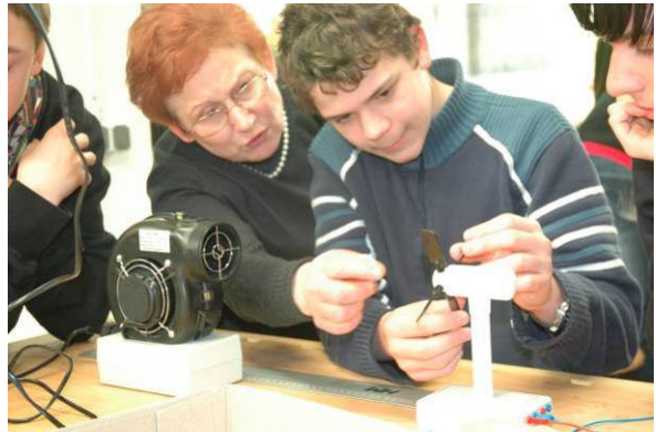
Einfluss der Stellung der Rotorblättern bei Windrädern / Ertragsmessung
