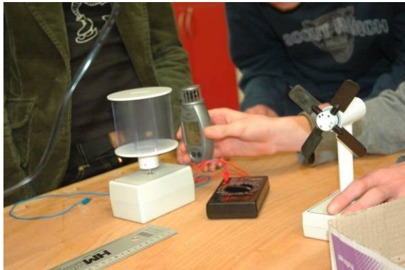
Messung der Windstärke / des Ertrags bei verschiedenen Windgeneratoren
