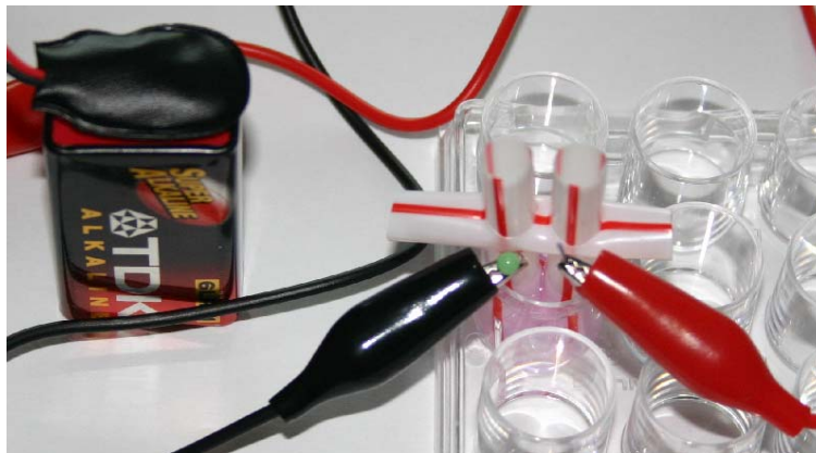
Elektrolyseapparatur (Chlor Alkali Elektrolyse) auf Basis der Mikrotiterplatte 24 und Trinkhalmen
