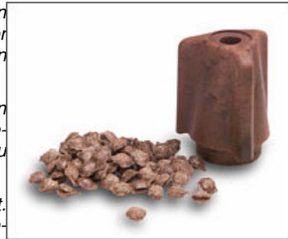
Qualitätsgrundsatz von ARBOFORM® Thermoplastische Werkstoffe aus nachwachsenden Rohstoffen unterliegen mitunter einer stark schwankenden Qualität. Die Matrix des Werkstoffs ARBOFORM® dagegen besteht aus Lignin, welches als Koppelprodukt im Zellstoffaufschlussprozess gewonnen wird und deshalb wie der Zellstoff für die Papierherstellung selbst ein Höchstmaß an Qualitätskonstanz besitzt.
