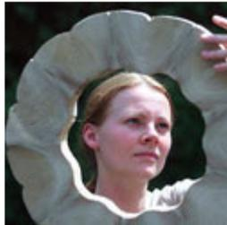
Verarbeitung nachwachsender Rohstoffe, umweltverträglich, geringes Leistungsgewicht der Faserverbünde, recyclebar, kompostierbar: Holzrohrquerschnitte gewonnen durch Verdichtung/ Formung, Materialeinsparung von etwa 80% bezogen auf Rundholz, 50% resultieren aus der Abfallvermeidung in der Sägerei, rest durch effiziente Proflanordnung
