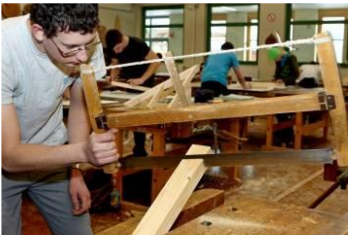
Abbildung 11: Modell 01 in PA Anbei ein Lehrling beim Abbinden (Zuschnitt der Konstruktionsteile) seines Modells.
