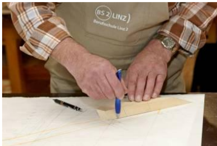
Abbildung 10: Modell 01 in PA Die grafischen Darstellungen wurden auf die Holzteile übertragen. In weiterer Folge sind die Hölzer in Handarbeit zugeschnitten und zu einem fertigen Modell verschraubt worden.
