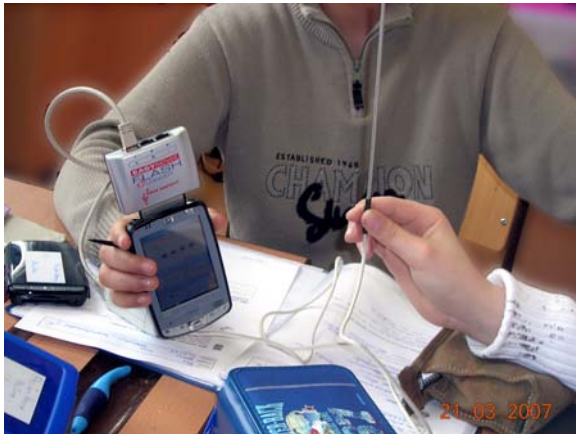
Richtiges Halten des Temperatursensors und Messen an einem Holzstück
