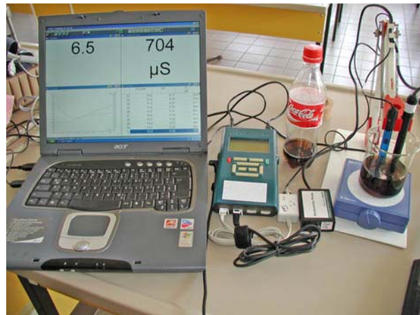
Abb. 3.4.5 Versuchsaufbau zur Cola - Titration
