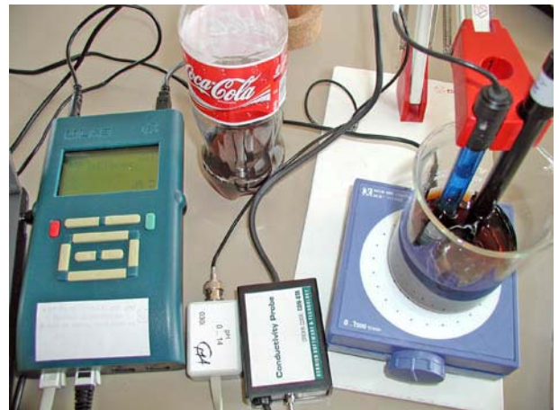
Abb. 3.4.6 Gleichzeitige Messung von pH und Leitwert
