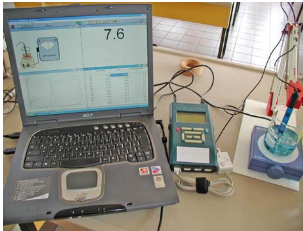
Abb. 3.4.1 Versuchaufbau zur Bestimmung der Säurekonstante
