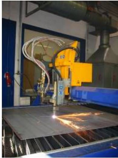
**Abbildung 4: Die Computergesteuerte Maschine schneidet die Bodenplatte aus**
