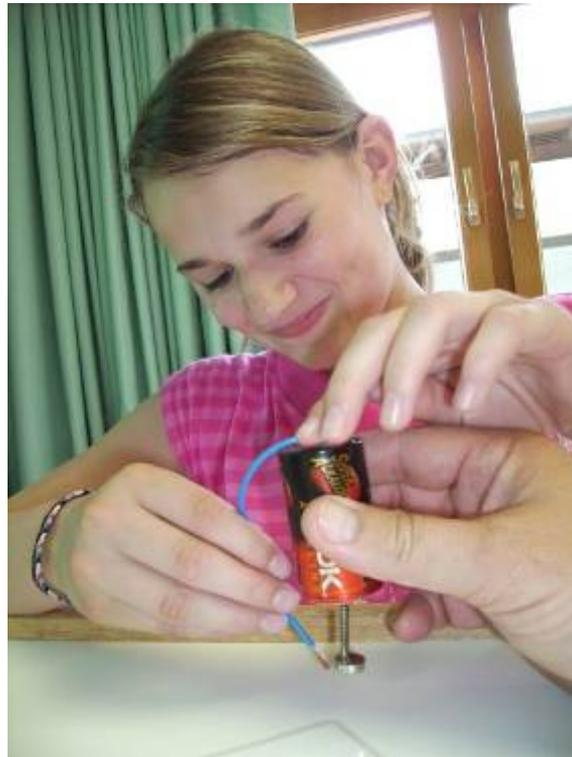
Abb. 1: Kleiner Elektromotor
