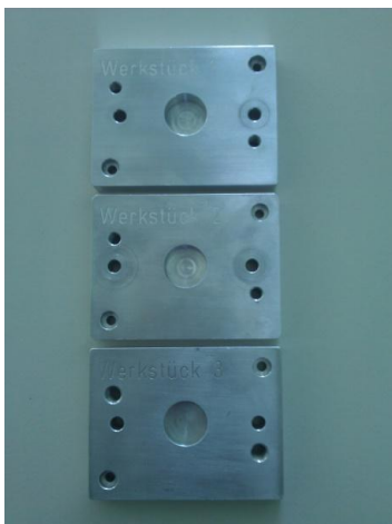
Abbildung 4: drei Prüfkörper mit unterschiedlichen Abmessungen
