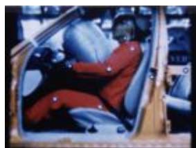
Phasenfotos eines sich öffnenden Airbags
