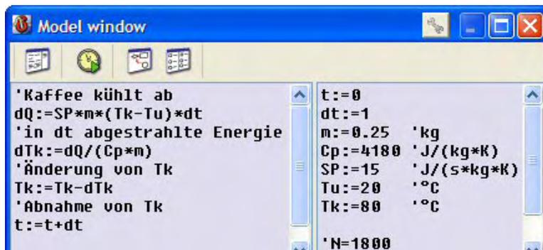
Bei der Lösung dieser Aufgabe im Textmodus ist man fast näher an den bekannten Formeln der Physik. Als erstes wird die Energie berechnet, die im Zeitintervall  $dt$  abgestrahlt wird. Daraus entsteht durch Umformen der Formel  $dQ = Cp \cdot m \cdot dT$  jene Temperatur-
