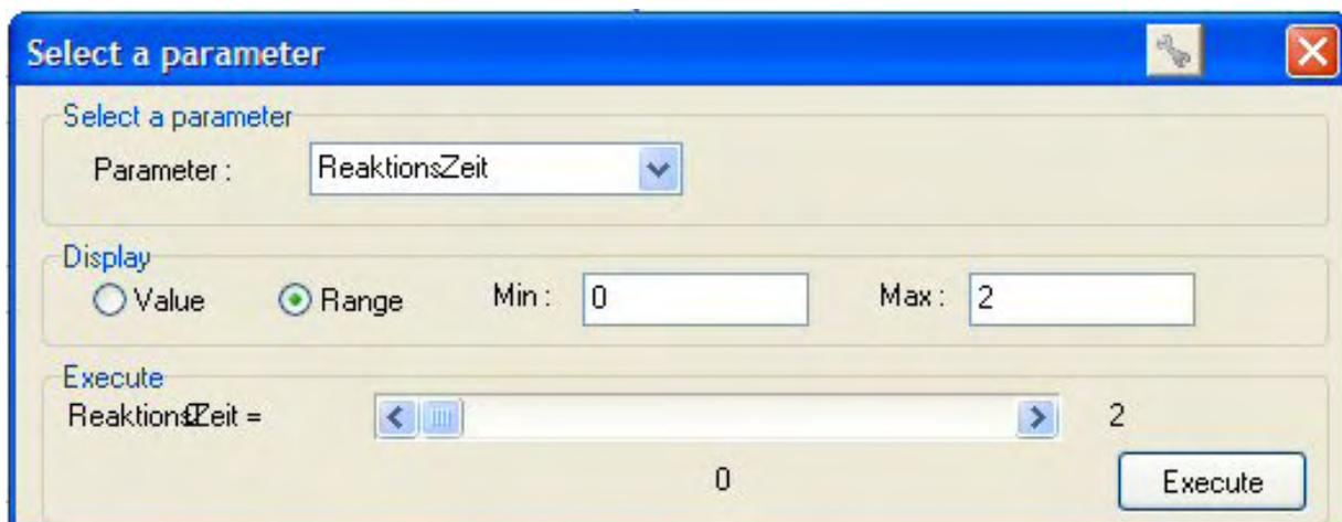
Es öffnet sich der oben sichtbare Dialog. Zuerst wird jener *Parameter* ausgewählt, dessen Wert variiert werden soll. Hier sollen Werte zwischen 0 und 2 Sekunden für die *Reaktionszeit* mit dem Schieberegler ganz unten eingestellt werden. Für jeden eingestellten Wert wird dann auf die Schaltfläche **Execute** geklickt. Dabei wird das Modell für diesen Wert durchgerechnet und sein Graph ins Diagramm gezeichnet.
