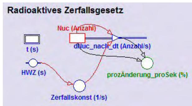
Die Bestandsgröße **Nuc** (Abkürzung für Anzahl der Radionuklide) hat einen Startwert von 100000 und verringert sich im Laufe der Zeit; deshalb hat Nuc einen **Outflow**. Der Outflow ist die Änderungsrate von Nuc und gibt an, wie stark sich die Bestandsgröße Nuc innerhalb der Zeiteinheit (allg. innerhalb der Einheit der unabhängigen Variablen) ändert. Diese Änderung pro Zeiteinheit hängt
