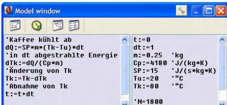
Bei der Lösung dieser Aufgabe im Textmodus ist man fast näher an den bekannten Formeln der Physik. Als erstes wird die Energie berechnet, die im Zeitintervall  $dt$  abgestrahlt wird. Daraus entsteht durch Umformen der Formel  $dQ = Cp * m * dT$  jene Temperatur-
