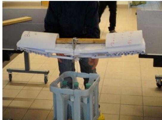
Abb. 26: Prüfung der Belastbarkeit
