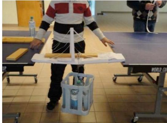
Abb. 24: Prüfung der Belastbarkeit
