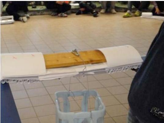
Abb. 25: Prüfung der Belastbarkeit
