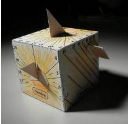
Abb. 11 (oben): Bei der Horizontal- und Vertikaluhr sind die Zeigerwinkel erdachsparell
