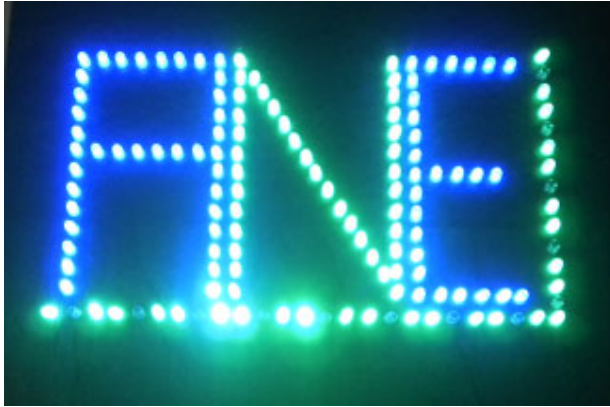
Beleuchtungskörper aus Plexiglas mit gefrästen Elementen
