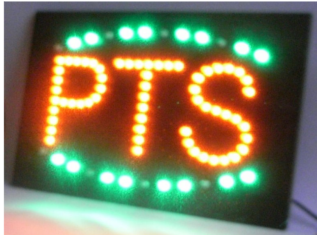
Bei dieser Werbetafel leuchten die Buchstaben PTS mit den orangenen Leuchtdioden statisch, während die grünen LED-Bögen von der abgebildeten Schaltung angesteuert werden.
