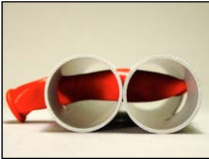
Materialexperimente zur Erfindung neuer formschlüssiger Verbindungen. Luftballons, die durch Bohrungen in Plastikrohre gesteckt und aufgeblasen werden, ergeben flexible Gelenkverbindungen. Idee: Gregor Stolz, Kingston University London am New Design Centre St. Pölten, 2004. (Foto: James Skone)
