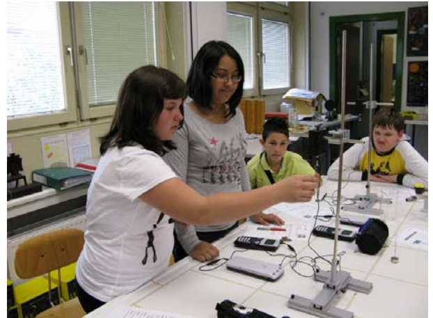
Der Kraftsensor ersetzt den Federkraftmesser
