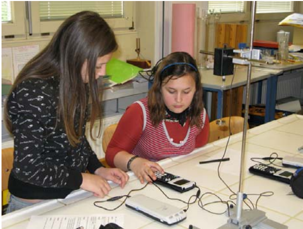
Der Kraftsensor ersetzt den Federkraftmesser
