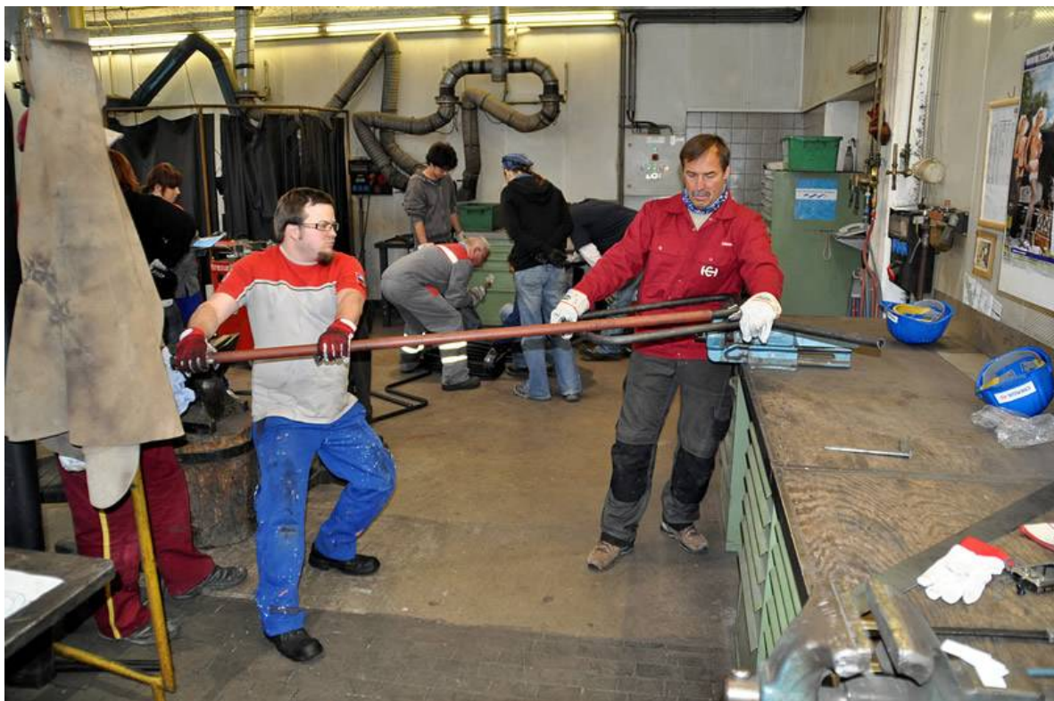
Abb. 15: Ausrichten der gebogenen Form.
