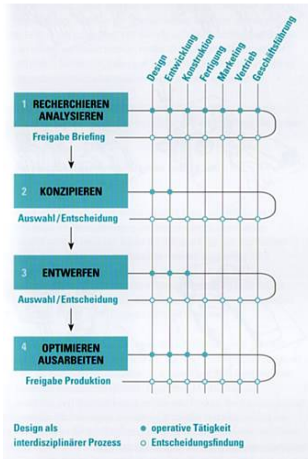
Abb. 50: Industrial Design: Interdisziplinärer Prozess in der Produktentwicklung nach Heufler.
