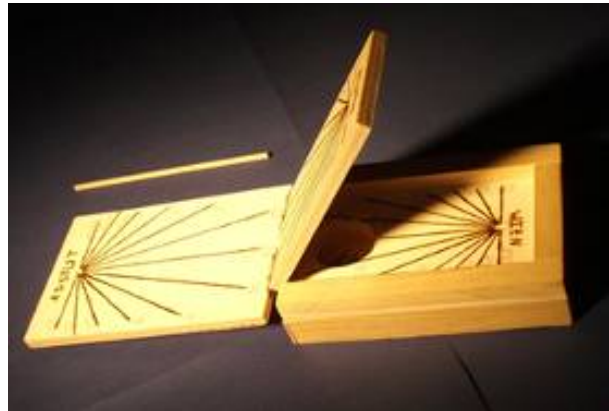
Abb. 25, 26: Tragbare Sonnenuhren (ausgestattet mit Mini-Kompass zum Einnorden)
