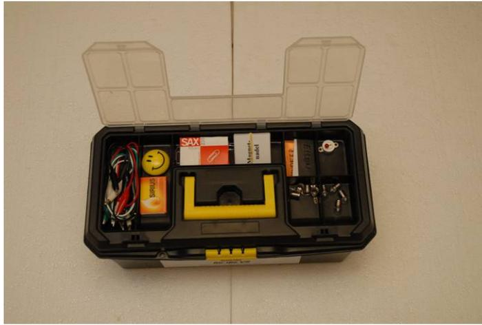
Die mittlere Etage ist der Länge nach unterteilt und beinhaltet folgendes: 2 Stabmagnete in einer Styroporverpackung, 1 Taschenlampenbatterie 4,5V, 2 Holzklammern, 1 Flüssigkeitsthermometer, 2 Kunststofflöffeln, 2 kleine Teelichter, 2 große Teelichter, 3 Schaschlikstäbchen
