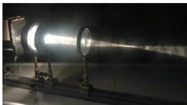
Abb. 4: Sichtbarer Strahlengang beim Modell eines Diaprojektors
