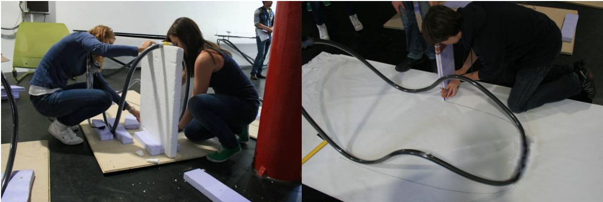
Bau der Stützeinrichtung für den Infusionsvorgang und Abnahme der projizierten Rahmenkontur für die Sitzbe- spannung
