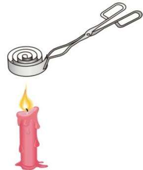
3. Versuch: Wir machen den gleichen Versuch wie vorher mit einem Bimetallstreifen. Drehe den Bimetallstreifen auch um.
